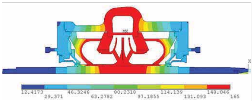
Рис. 6. Поле температур на 3600-й секунде с момента пуска предвключенного насоса, °C
