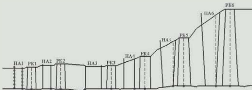
Рис. 4. Меридиональная проекция проточной части турбины Т-3.3/5.5-0.5/0.22/0.01
