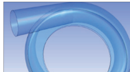
Рис. 9. Область «А» улитки, в которой наименьшее сечение спиральной камеры примыкает к выходному диффузору
