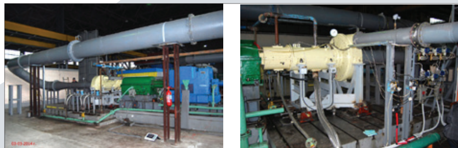
Рис. 2. Аэродинамический стенд (АДС-1250) для испытаний модельных ступеней
