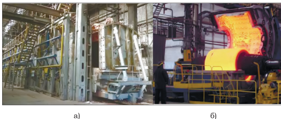
Рис. 2. Нагревательные печи: а) – нагревательная печь с выкатным подом, используемая для нагрева КГСПВ; б) – печь скоростного нагрева валков [7]
