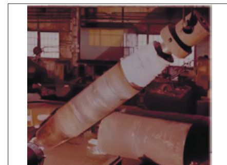
Рис. 5. Укладка демонтированной оси вала на прокладки в пролете цеха
