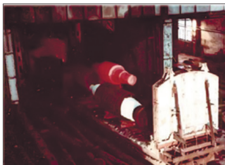
Рис. 3. Нагретый валок под демонтаж на выкатном поде, перед съемом
