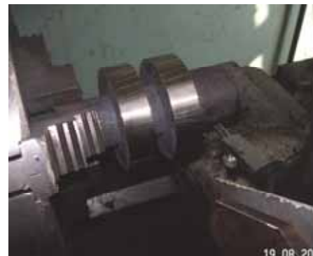
Рис. 1. Схема упрочнения образцов в автоматизированном режиме
