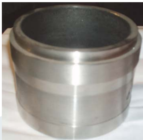
Рис. 6. Статорная втулка насоса, упрочненная методом ЦЭАЛ
