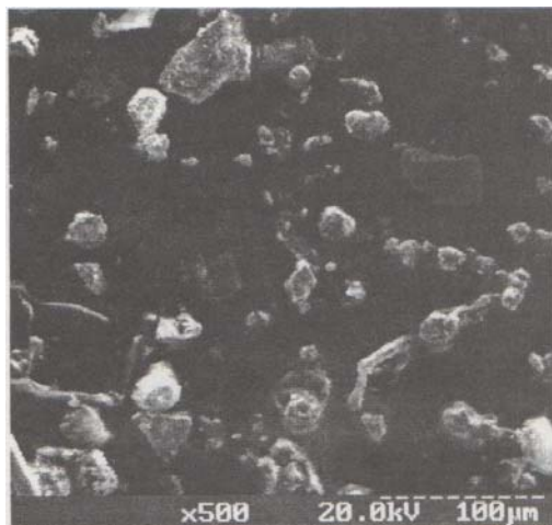
Рис. 3. Фото примесей, извлеченных из смазки автомобиля «Шевроле Авео»
