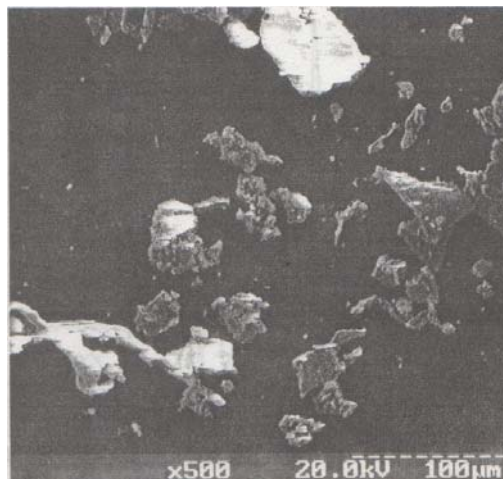
Рис. 4. Фото примесей, извлеченных из фильтра автомобиля «Славута»
