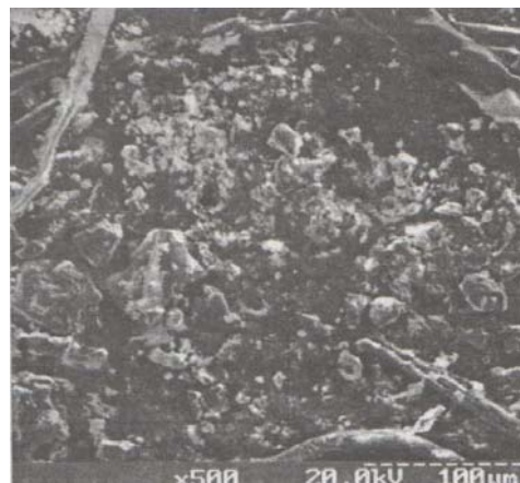
Рис. 6. Фото примесей, извлеченных из смазки автомобиля «Газель»
