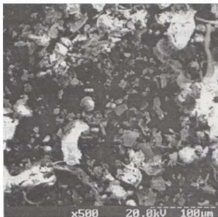
Рис. 5. Фото примесей, извлеченных из фильтра автомобиля «Шевроле Авео»
