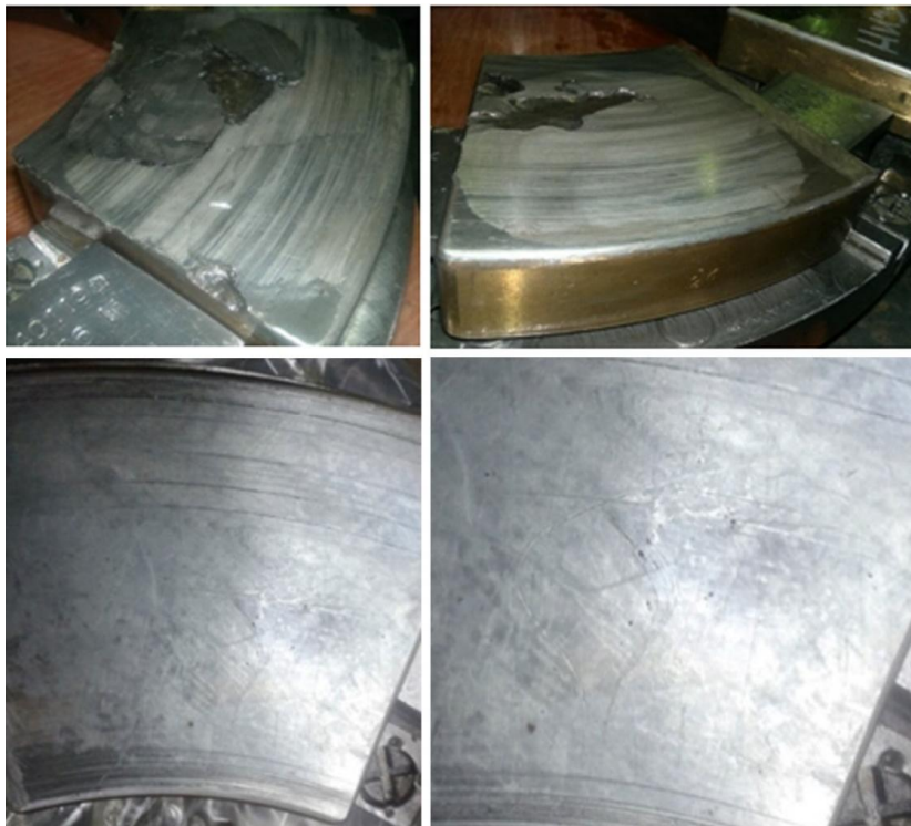
Рис. 4. Следы электроэрозии на штатных упорных колодках
