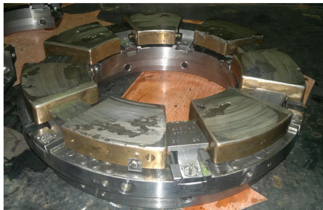
Рис. 2. Изношенные штатные рабочие упорные колодки
