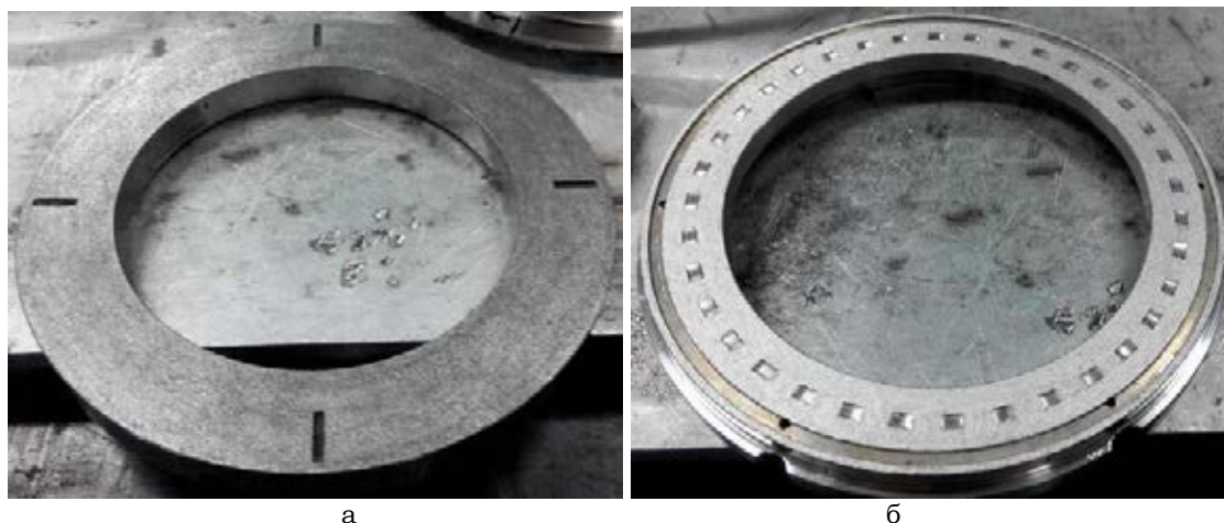
Рис. 1. Кольца торцевого импульсного уплотнения: а – опорное кольцо, б – аксиально-подвижное кольцо
