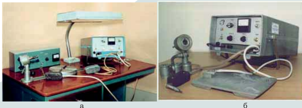
Рис. 1. Установки электроэрозионного легирования: а – стационарная «ЭИЛ-8», б – переносная: «ЭИЛ-8А».
