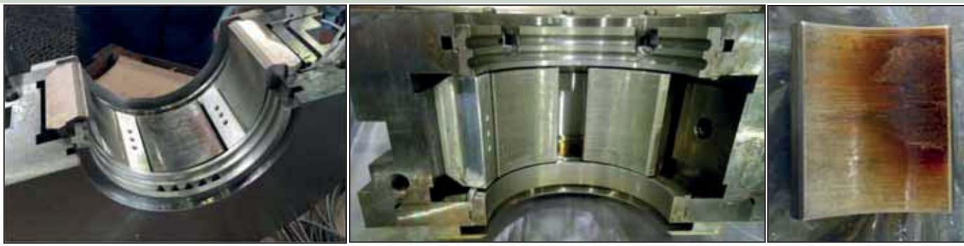
**Рис. 1. Состояние опорной части ПОУ при ревизии:** а – нижняя часть; б – верхняя часть; в – наиболее нагруженная колодка.
