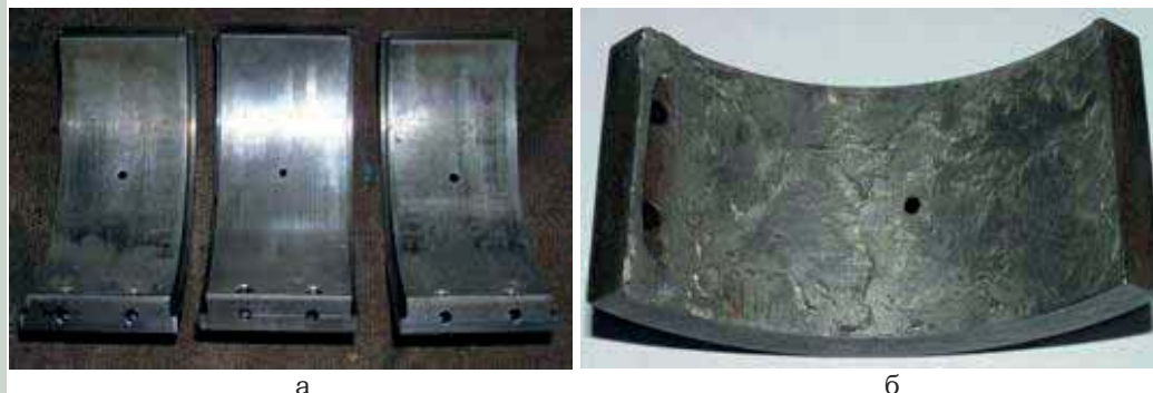
Рис. 3. Разрушение антифрикционного слоя ВП в результате: а – абразивного износа и образования натиров, б – кавитации и усталостного изнашивания.
