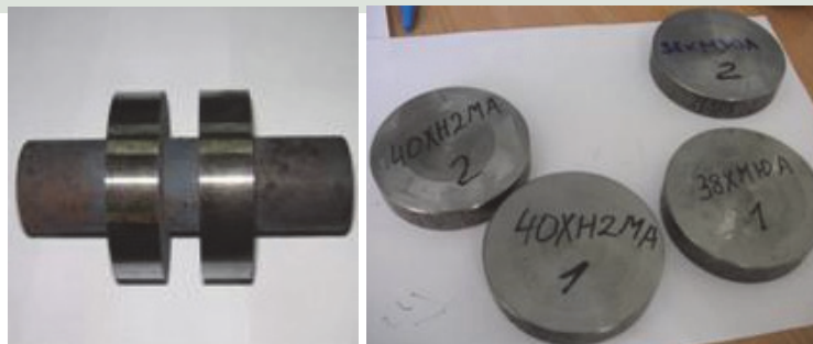
Рис. 3. Стальные образцы для исследования результатов ЦЭЭЛ.
