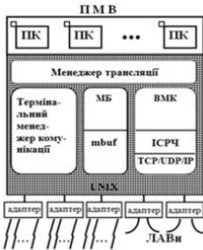
Рис. 4. Структура програмного забезпечення ПДВЗ
