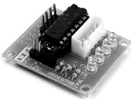
Рис. 2. Драйвер крокового двигуна ULN2003
