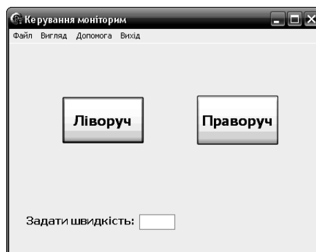
Рис. 4. Інтерфейс програмного забезпечення для управління кроковим двигуном
