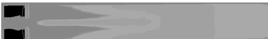
Рис.4. Розподіл поля температур в трубі з дроселем
