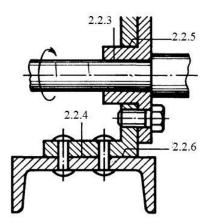
2.2.3. Рухоме з'єднання Подвижное соединение Movable joint
