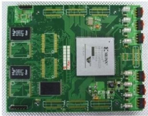
Рис. 1. Макетна платформа XILINX X2CV8000
