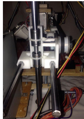
Рис. 2. Конструкція платформи руху по осі X
