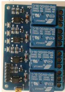
Рис. 5. Модуль реле чотирьохканальний
