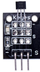
Рис. 3. Датчик Хола Hall KY-003
