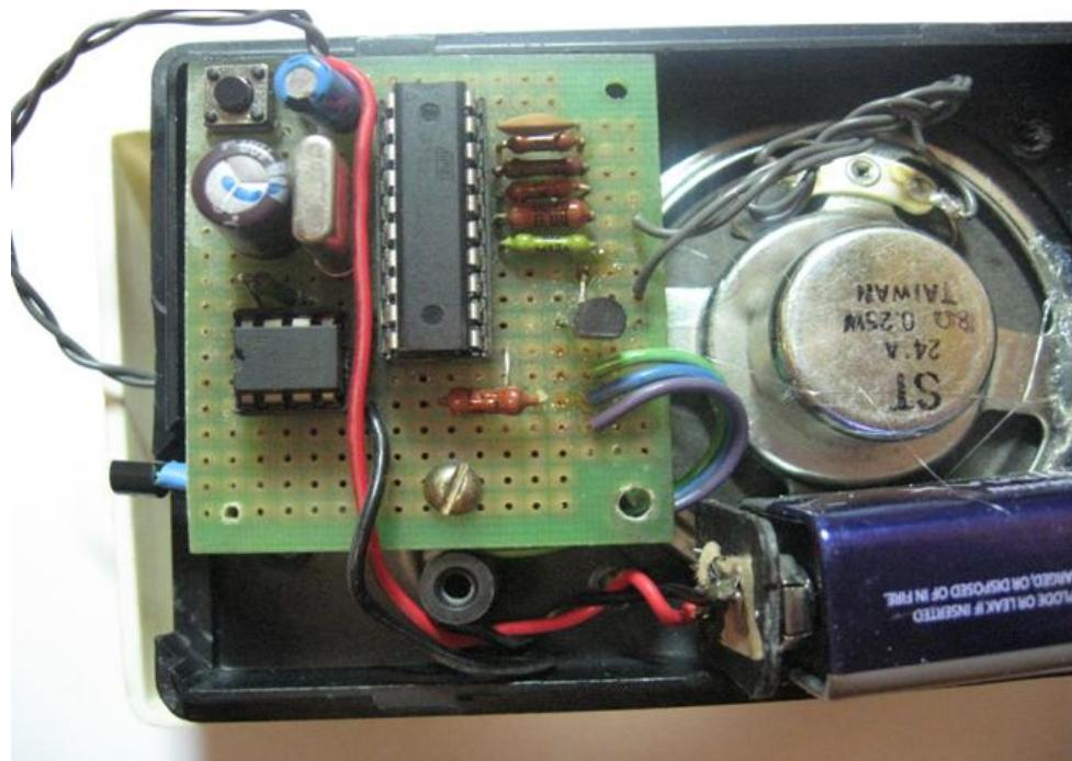
Рис. 2. Загальний вигляд електронного термометра з голосовим управлінням
