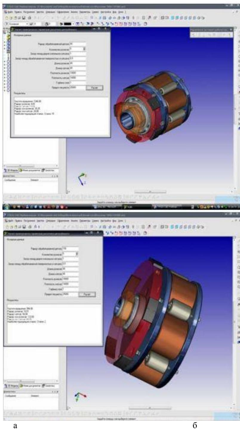
*Рис. 2. Відцентровий розкатник для обробки порожніх отворів діаметрами:
