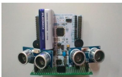
Рисунок 3 – Макет сенсора с двумя ультразвуковыми датчиками
