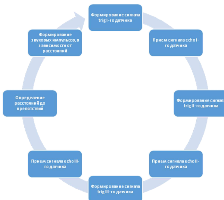
Рисунок 4 – Алгоритм работы микроконтроллера с тремя сенсорами
