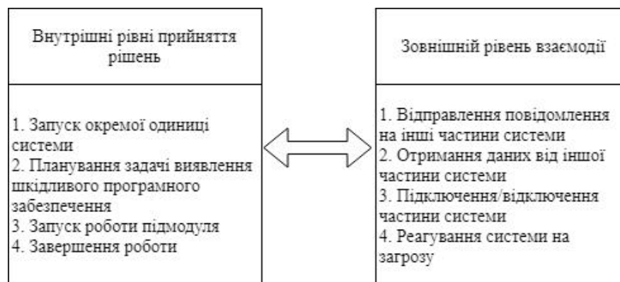
Рис.3. Схема взаємодії внутрішнього та зовнішнього рівнів
