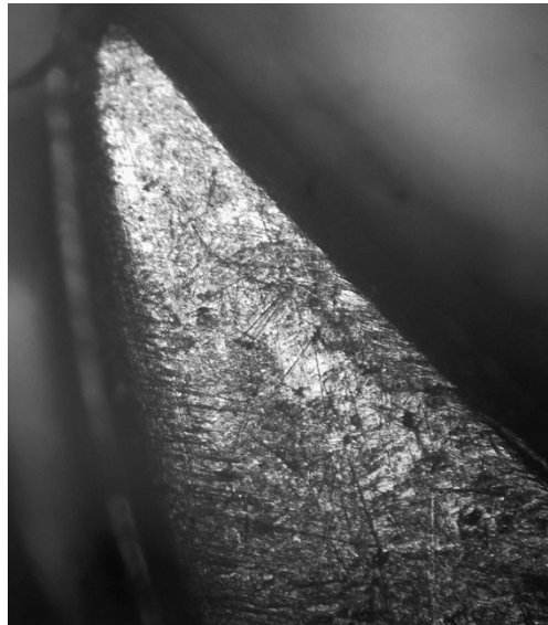
Рис. 21. Зношування (змінання) краю друкуючого елемента: а) зміцненого зразка, (збільшення – 50 разів); б) змінання і активне абразивне зношування аналогічного елемента стандартного штампа, (збільшення – 50 разів)
