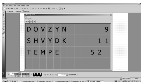
Рис. 5. Вікно текстових повідомлень на дисплеї LOGO! в режимі симуляції
