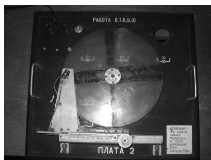
Рис. 3. Загальний вигляд датчика блоку вимірювання довжини та швидкодії ФДМ
