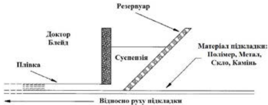
Рис. 1. Схема філь'єри для плівкового лиття
