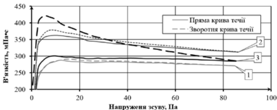
Рис. 7. Залежність в'язкості від напруження зсуву для суспензій з різним вмістом порошку: 1 - TCS-17 (19% мас. порошку); 2 - TCS-14 (30% мас. порошку); 3 - TCS-22 (33% мас. порошку).
