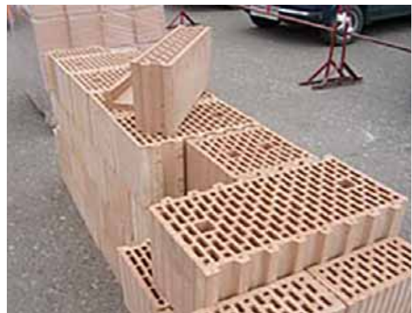
Рис. 1. Стінові блоки будівельної системи із пористо-порожнотілої кераміки
