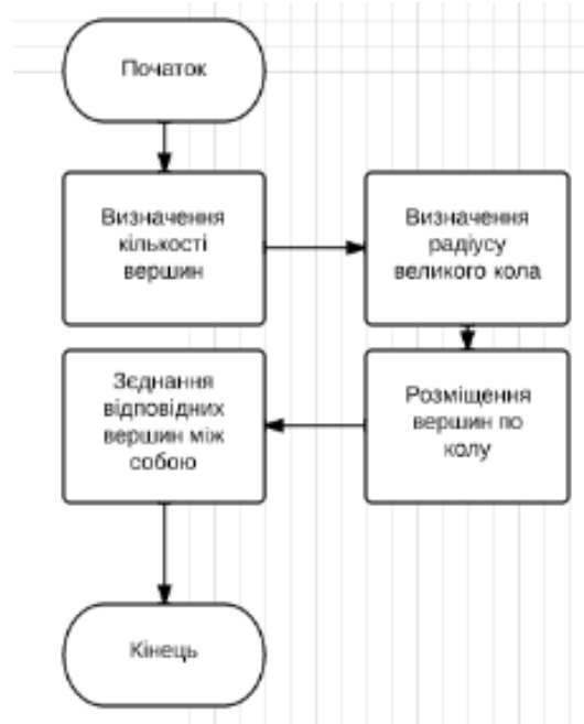
Рис. 7. Блок схема алгоритму формування кругового графу
