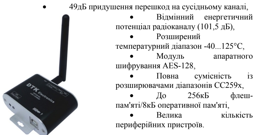
Рис. 2. Приймально-передавальний пристрій Zigbee
