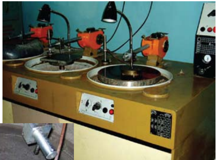
Рис. 3. Устаткування та інструмент для фінішної обробки зразків природного каменю: а – верстат марки ЗШП-320; б – інструмент із зв'язаним абразивом
