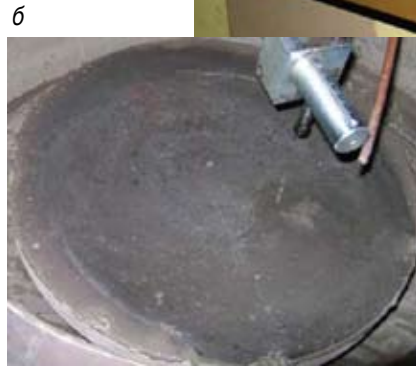
Рис. 3. Устаткування та інструмент для фінішної обробки зразків природного каменю: а – верстат марки ЗШП-320; б – інструмент із зв'язаним абразивом
