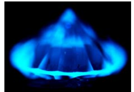
Фото 8. Природний алмаз. Огранування – Кр-57, маса – 0,35 ст. Спостерігаються нечіткі, але помітні і достатні для діагностики природні структури росту
