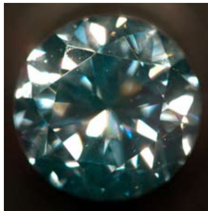
Фото 29, 30. Блакитний синтетичний алмаз. Вид з боку корони. Огранування – Кр-57, маса – 0,31 ct. Алмаз у видимому світі (ліве фото) та той самий алмаз після опромінення УФ-світлом (праве фото). Добре спостерігається світіння блакитного кольору
