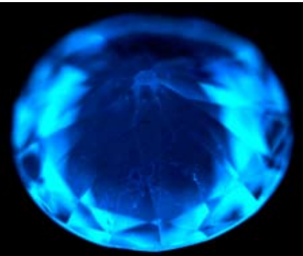
Фото 11. Природний алмаз. Огранування – Кр-57, маса – 0,50 ct. Помітні фігури росту у вигляді полігональної сітки
