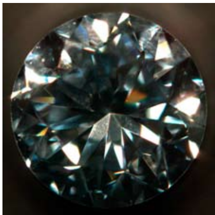
Фото 29, 30. Блакитний синтетичний алмаз. Вид з боку корони. Огранування – Кр-57, маса – 0,31 ct. Алмаз у видимому світі (ліве фото) та той самий алмаз після опромінення УФ-світлом (праве фото). Добре спостерігається світіння блакитного кольору
