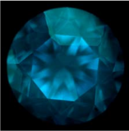
Фото 35. Блакитний синтетичний алмаз. Вид з боку корони. Огранування – Кр-57, маса – 0,33 ст. Фігура росту за кубооктаедром добре помітна завдяки зелено-синій люмінесценції
