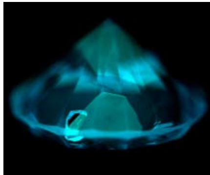
Фото 37, 38. Блакитний синтетичний алмаз. Вид з боку павільйона. Огранування – Кр-57, маса – 0,30 ст. Добре спостерігається досить велике металічне включення як у видимому світлі (ліве фото), так і в ультрафіолетовому (праве фото)
