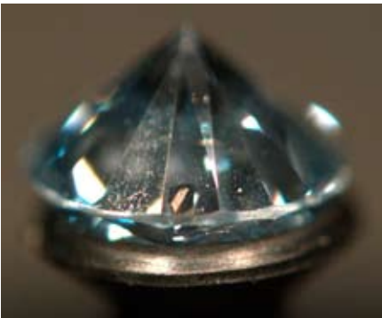
Фото 37, 38. Блакитний синтетичний алмаз. Вид з боку павільйона. Огранування – Кр-57, маса – 0,30 ст. Добре спостерігається досить велике металічне включення як у видимому світлі (ліве фото), так і в ультрафіолетовому (праве фото)
