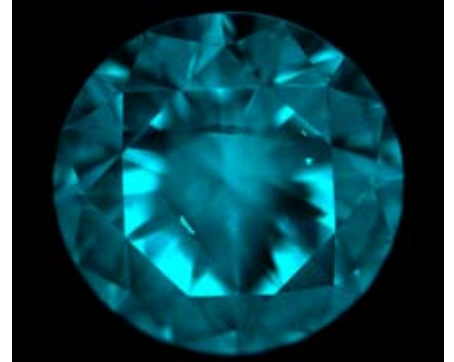
Фото 20. Безбарвний синтетичний алмаз. Вид з боку корони. Огранування – Кр-57, маса – 0,34 ct. Характерні металеві включення в синтетичному алмазі
