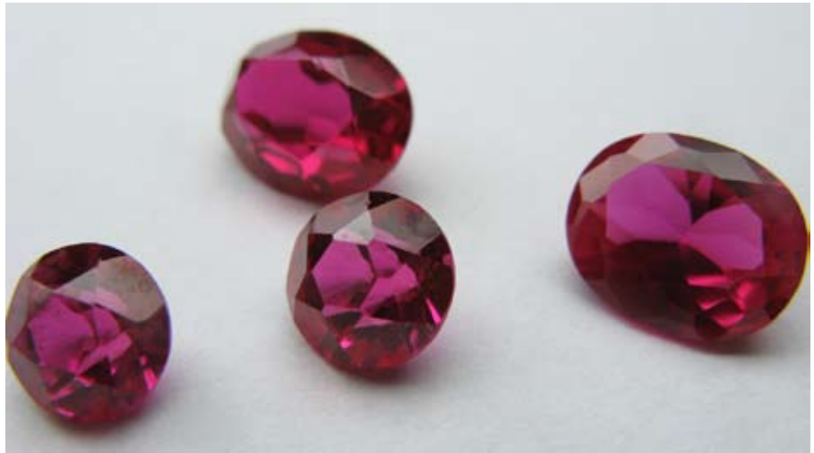
Рисунок 1. Ювелірні вставки синтетичних рубінів (метод Вернейля)
