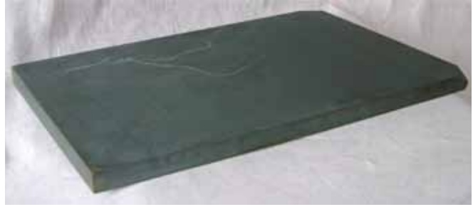
Рисунок 1. Плита з яшми технічної для притирання оптичних деталей з середньою шорсткістю Ra = 0,015 мкм
