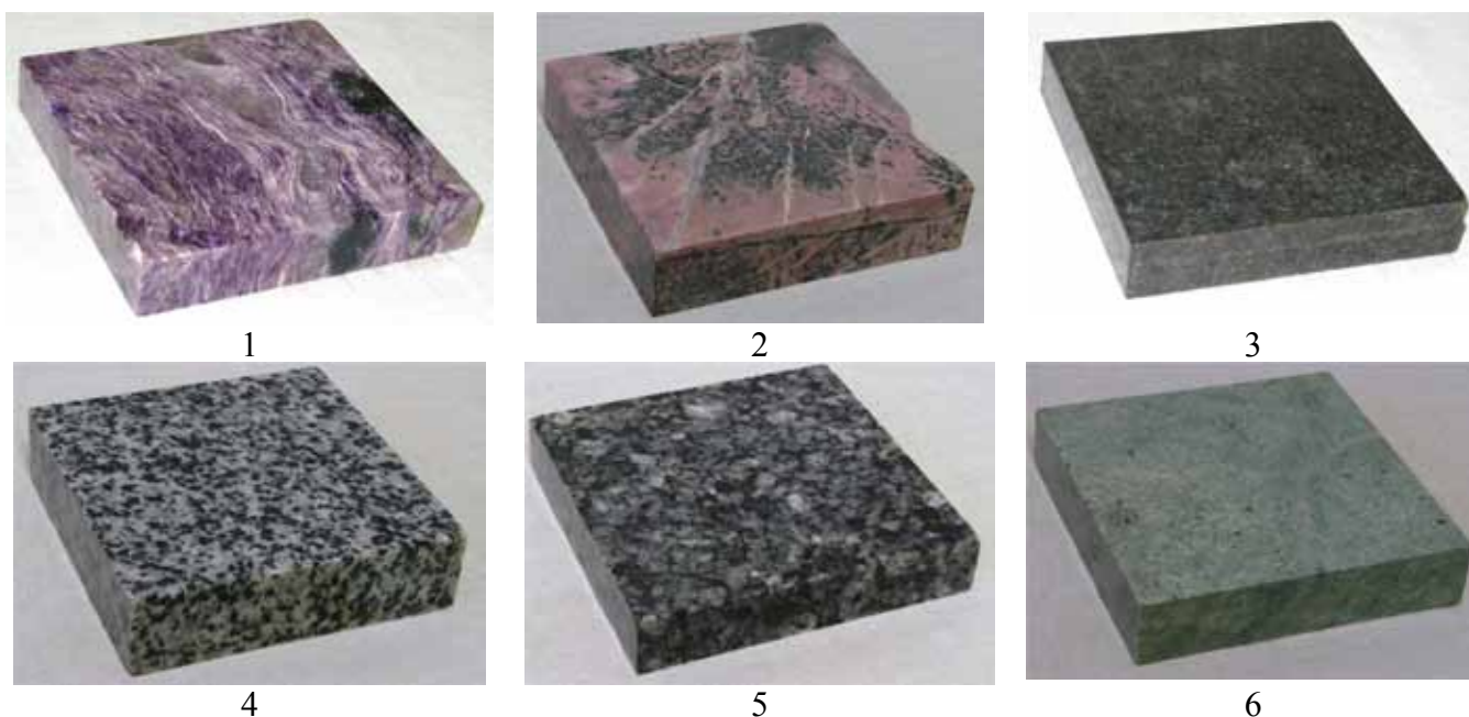
Рисунок 1. Зразки каменів, які належать до різних груп за оброблюваністю: третя: 1 – чароїт, 2 – родоніт (Росія), 3 – габро (Україна); четверта: 4, 5 – граніти (Україна), 6 – жадеїт (Росія)
