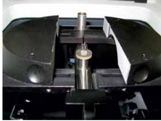
Рисунок 2. ІЧ-спектрометр «Thermo Nicolet 6700 FTIR» з приставкою «Collector II»
