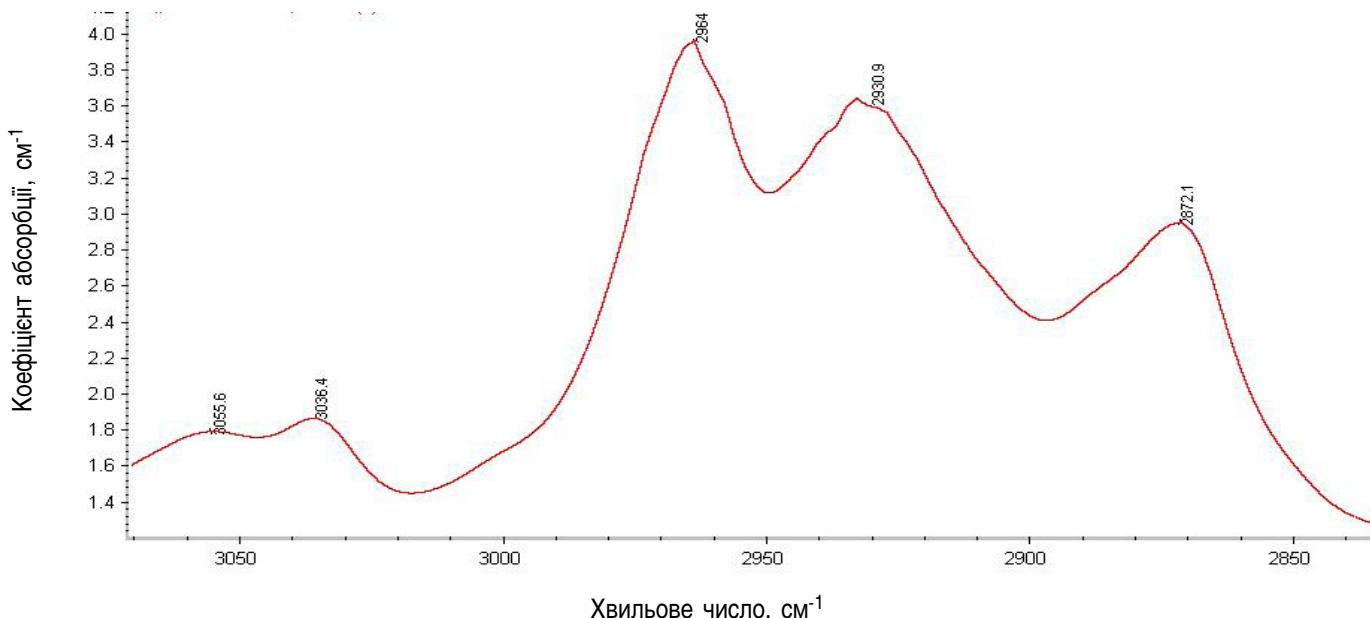
Рисунок 8. Інфрачервоний спектр заповнювача (полімеру?) у жадеїті
