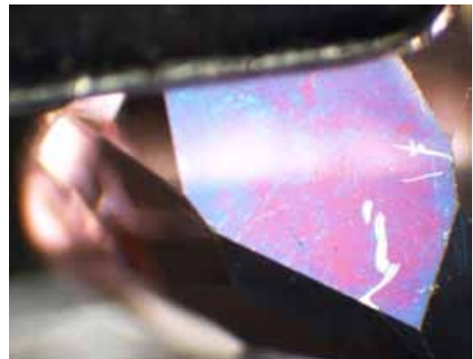
Рисунок 2. Райдужна поверхня плівки та подряпини на гранях топазу. Збільшення \times 16
