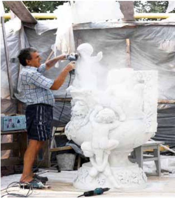
Рисунок 7. Виготовлення скульптурних виробів ручним (а) та автоматизованим (б) способами
