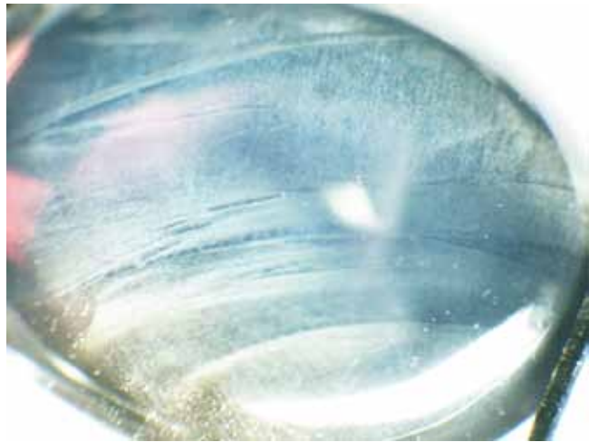
Рисунок 4. Тонкий шар сірої плівки на поверхні синтетичного сапфіра
