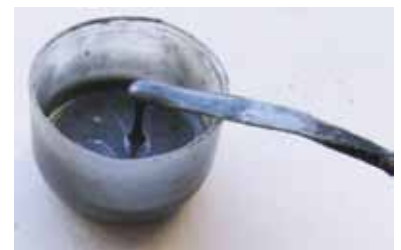
Рисунок 7. Вигляд типової наповненої епоксидної композиції для виготовлення відбитків і копій
