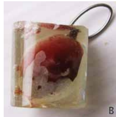
Рисунок 4. Приклади заливки (або обмазування) епоксидною смолою і затвердіння водомістких невисушених зразків: А) вдалий; Б) порівняно вдалий (хрущ); В) частково вдалий (плід шипшини), Г) невдалий (плід шипшини)
