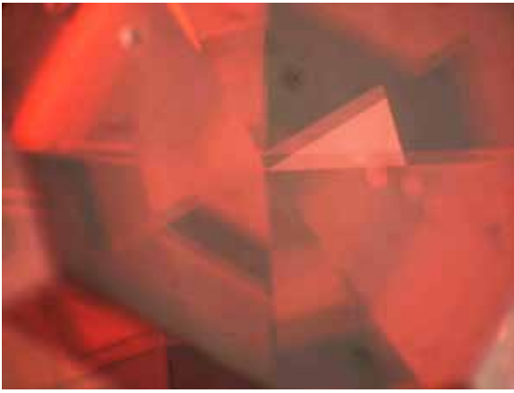
Рисунок 3. Роздвоєння ребер у цирконі внаслідок великого двозаломлення, зб. 30
