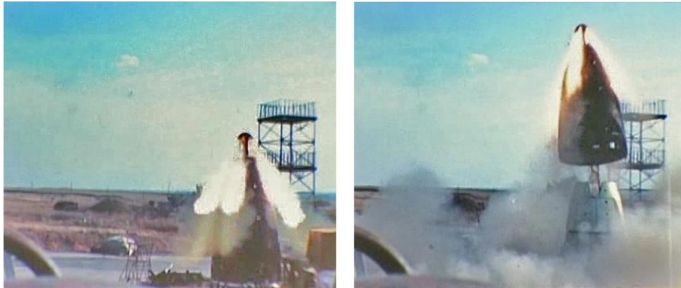
Рис. 4. Отработка системы отделения головного аэродинамического обтекателя изделия 15А18М
