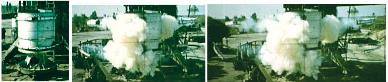
Рис. 3. Отработка системы отделения поперечных опор изделия 15Ж61 БЖРК: а – исходное состояние опытной конструкции – макет ракеты с двумя верхними поясами опор; б, в – моменты разлета опор.
