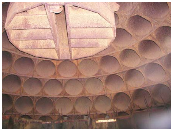
Рис. 6. Внутренний вид трубчатой камеры для сварки взрывом, рассчитанной на 200 кг взрывчатого вещества
