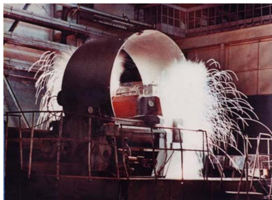
Рис. 2. Контактная стыковая сварка оболочек из алюминиевых сплавов
