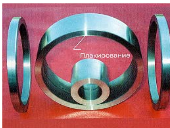
Рис. 7. Биметаллические детали, полученные сваркой взрывом
