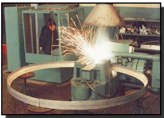
Рис.1. Контактная стыковая сварка шпангоутов из алюминиевых сплавов
