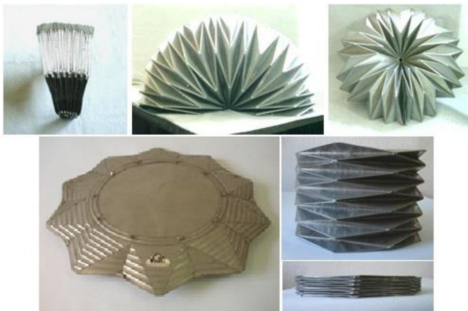
Рис. 2. Конструктивные решения складчатых КПО с оболочкой из аустенитных сталей толщиной 0,1–0,2 мм
