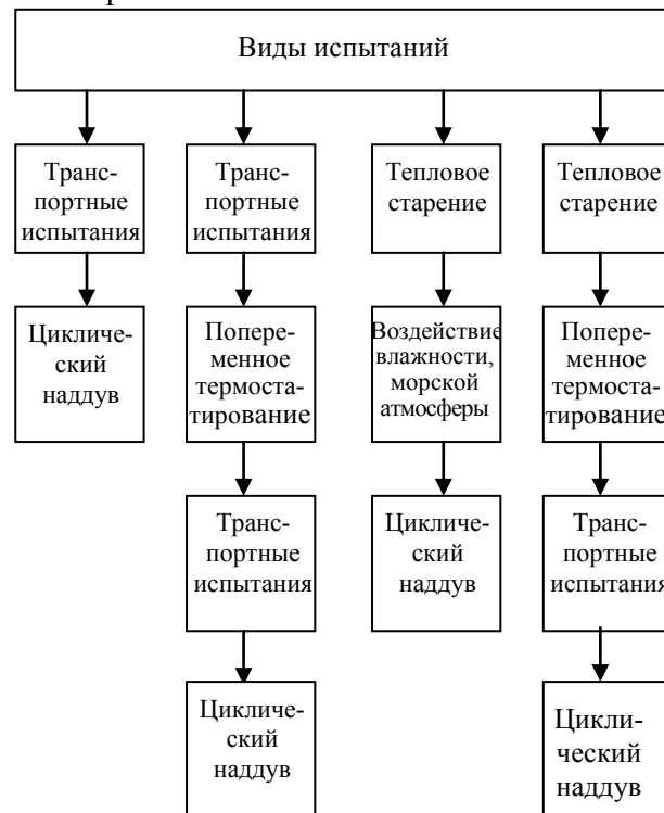
Рис. 2. Схема испытаний на последовательное воздействие нагрузок
