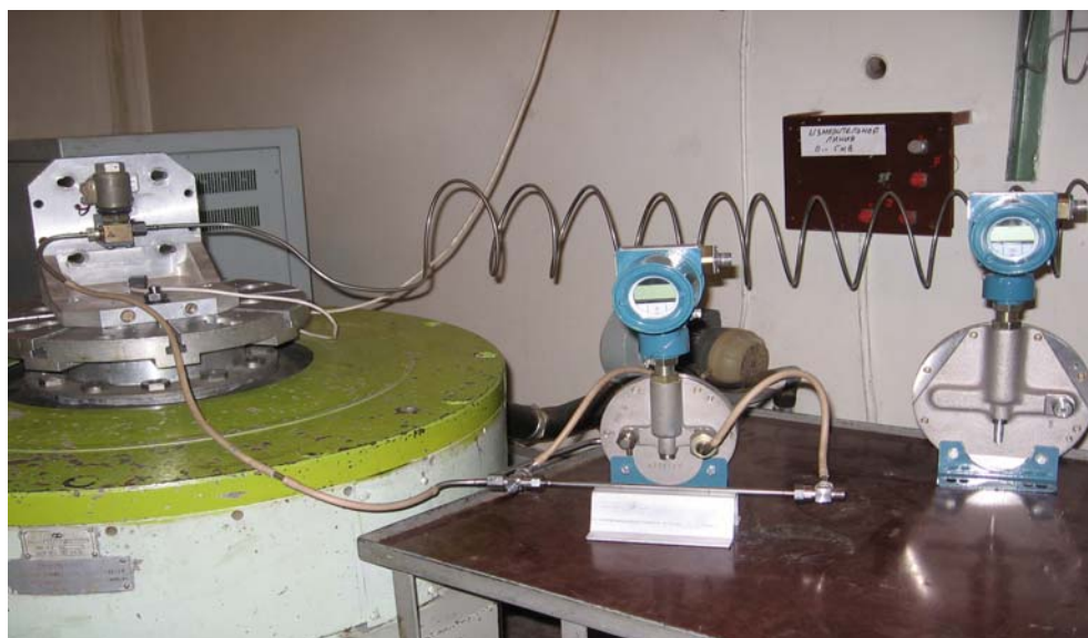
Рис. 2. Установка для измерения негерметичности агрегатов автоматики летательных аппаратов
