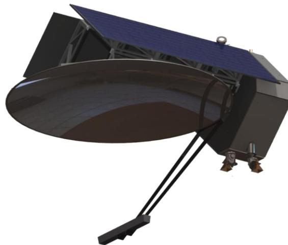
Рис. 7. КА ДЗЗ с радиолокатором
