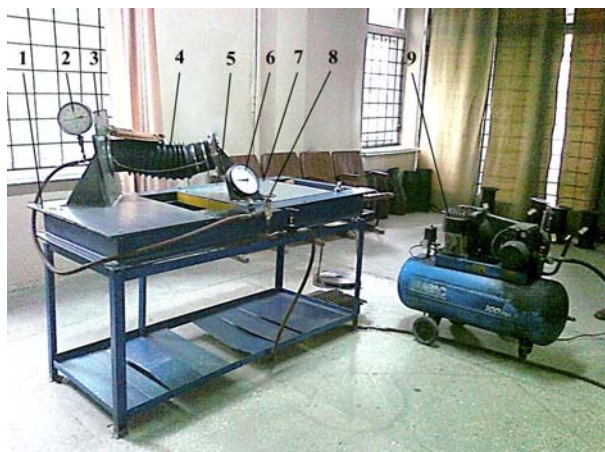
Рис. 2. Установка для испытаний узлов стыковки: 1 – неподвижный стол; 2 – манометр; 3 – панель; 4 – узел стыковки; 5 – панель; 6 – манометр; 7 – подвижный стол; 8 – вентиль; 9 – компрессор
