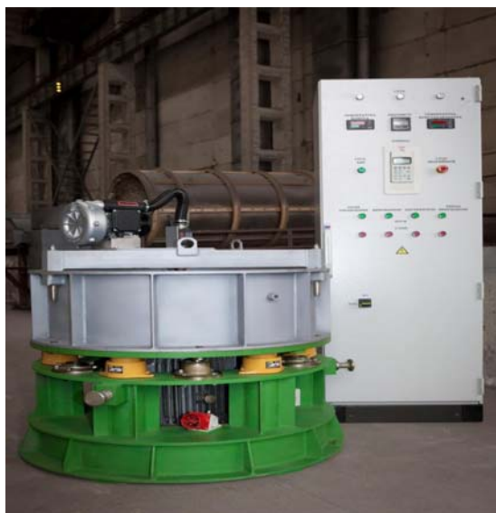
Рис. 1. Лабораторная установка для получения заготовок массой 30 кг
