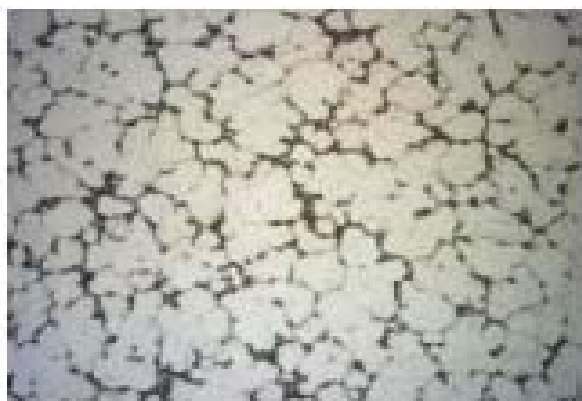
Рис. 7. Микроструктура традиционного литого сплава АМг-10
