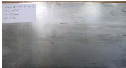
Рис. 5. Фотография проката, полученного из сегментированных заготовок АМг-10
