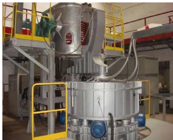
Рис. 2. Опытный образец промышленной установки для получения заготовок массой 200 кг
